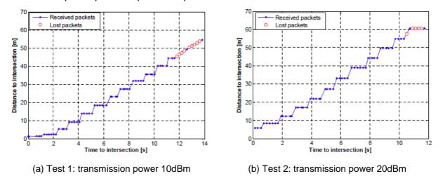
Figura 6. Distancia a la intersección para los ensayos de dimensionado de comunicaciones en intersecciones.
