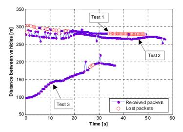
Figura 5. Distancia entre los dos vehículos para los ensayos de seguimiento y dimensionado de comunicaciones.
