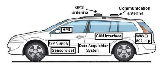
Figura 4. Esquema de vehículo instrumentado con prototipo de OBU ITS Cooperativo
